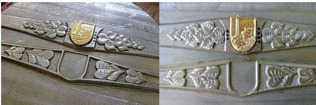
Fotografie z výroby – raznice, matrice vojenských prstenů a vkládání znaku pro zkoušku.
